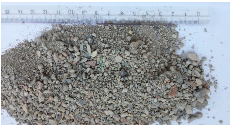
Fraktion von Mischgranulat zur Herstellung des zertifizierten CH-Portlandzements ZN/D 32,5 R.
