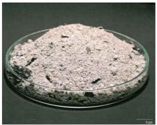
Bei der zulässigen Verbrennung von naturbelassenem Holz verbleibt eine feine, hellgraue, homogene Asche zurück. Die einzigen Fremdkörper in dieser Asche sind Kohleteilchen.
