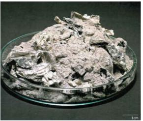
Das Mitverbrennen von Hausabfall hinterlässt in der schlecht ausgebrannten Asche Metallteile, Alufolie, "Kunststoffspuren" etc.
