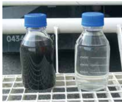
Links: Unbehandeltes Abwasser aus Strassensammlern. Rechts: Mobil aufbereitetes Abwasser. Quelle: AWEL Zürich
