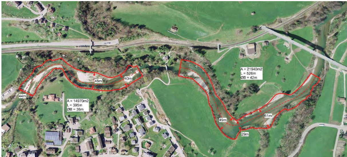
Abb. 40 Thur bei Lichtensteig mit zwei Referenzstrecken. A: Fläche Gewässersohle (dynamischer Bereich); L: Abschnittslänge; ØB: Mittlere Sohlenbreite. Zwischen den zwei Referenzstrecken befindet sich eine natürliche Engstelle (Fels).
