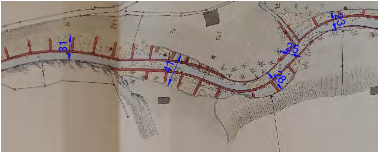
Abb. 26 Extrait du plan d'endiguement de 1893 à la hauteur de Kappelboden jusqu'à la confluence de l'Oberbach et de la Jogne, avec des largeurs pleins bords ( L_{pb} ) mesurées jusqu'à environ 40 m.
