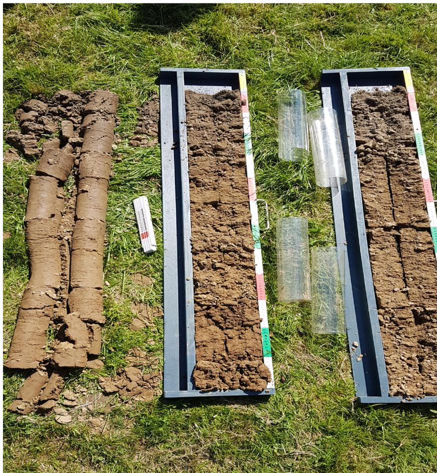
*Vom Bohrfahrzeug ausgehobene Bohrkern.*
