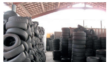
Reifenlager müssen immer mit einem befestigten Boden ausgestattet und nach Möglichkeit überdacht sein.
