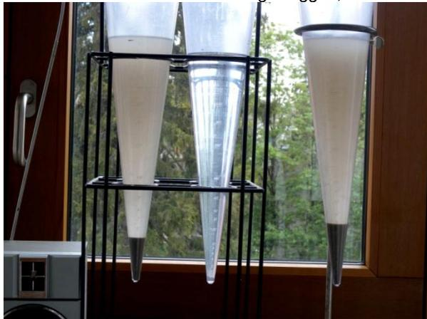
Abb. 3: Versuchsanordnung mit Imhofftrichter
