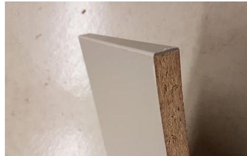
Kantenschutz einer Spanplatte für Möbelholz, Kunstharzbeschichtet
