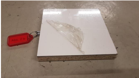
Hochglanzbeschichtung, kann halogenorganische Verbindungen enthalten
